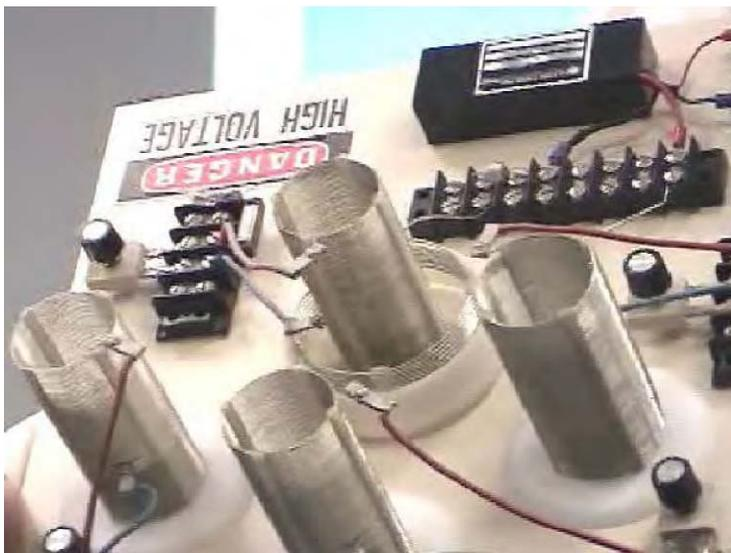
Все вторички заводского изготовления - одинаковые, бескаркасные, намотаны медным (посеребренным или луженым проводом) с шагом, витки удерживаются на расстоянии пластиковыми направляющими изнутри. Все катушки могут слегка отличаться, поэтому Смит н подстраивает контура подстроечными конденсаторами.
